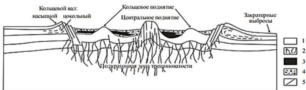
Рис. 1. Схема строения сложного метеоритного кратера (астроBLEMы): 1 – породы мишени; 2 – зона трещин в породах мишени (аутигенные брекчии); 3 – расплавленные импактиты (тагамиты, стёкла, шлаки); 4 – аллогенные брекчии и зювиты; 5 – разрывные нарушения [20] / Fig. 1. Diagram of a complex meteorite crater structure (astroblems): 1 – target rocks; 2 – crack zone in target rocks (autigenic breccias); 3 – molten impactites (tagamites, glasses, slags); 4 – allogeneic breccias and zovites; 5 – discontinuous disturbances [20]
